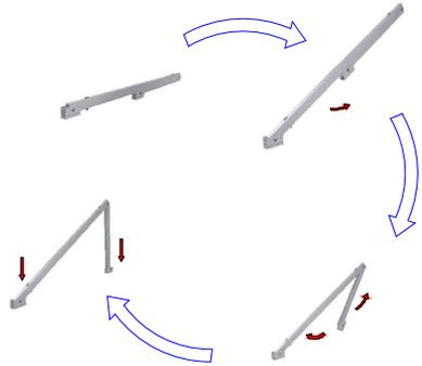
Se deben atornillar los 3 puntos de anclaje, empezando por la base delantera
