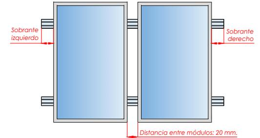
Fijación de los módulos con los presores y colocación de las tapas G1
