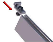
1. Insertar la fijación de perfil en interior de la guía
