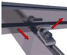
2. Levantar la fijación de perfil y colocar el perfil guía.
