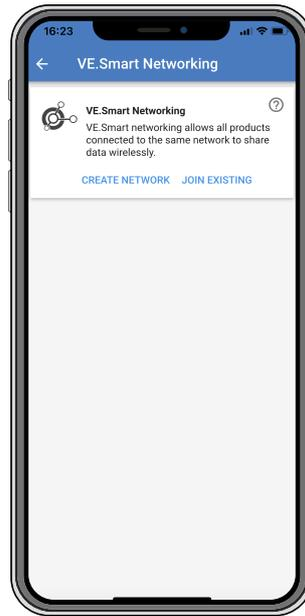
La red VE.Smart permite que varios productos conectados a la misma red compartan información por Bluetooth y está especialmente diseñada para sistemas pequeños que no tienen un dispositivo GX instalado.
