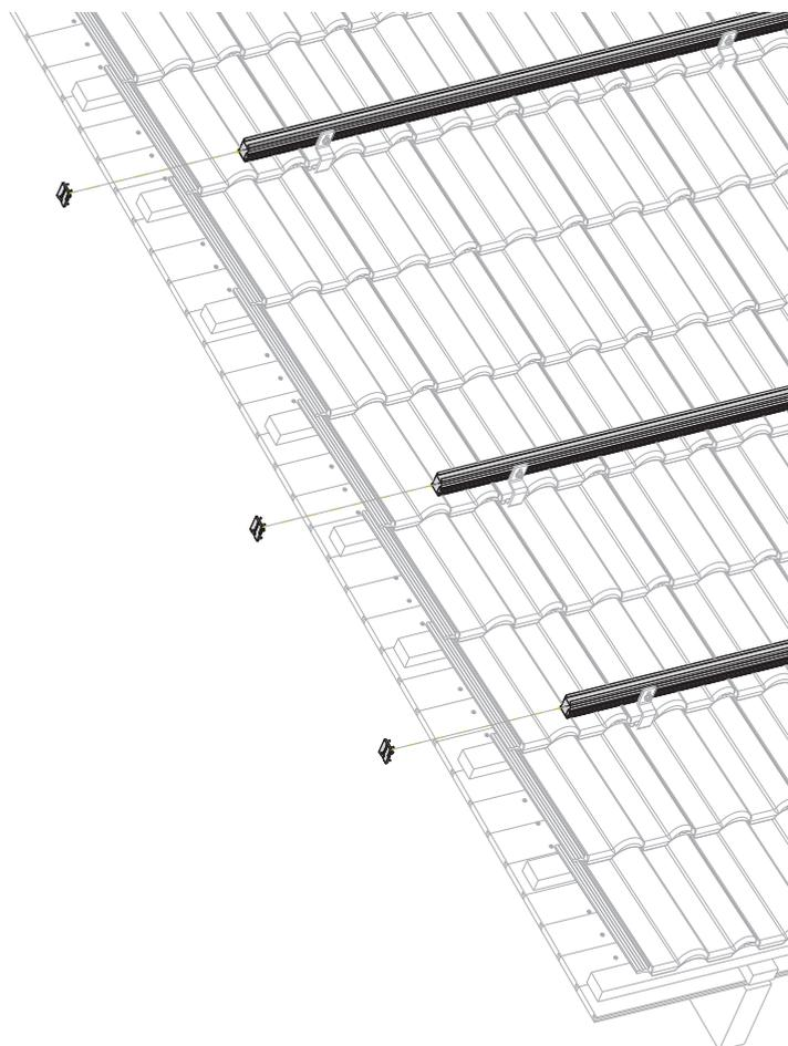
Sistema de perfiles de una longitud con fijación en el revestimiento de madera: alineación vertical
