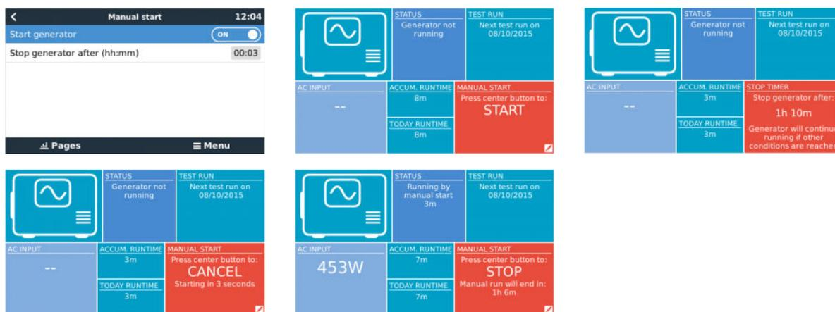
**ADVERTÊNCIA:** Se o gerador for ligado manualmente (de forma remota) sem utilizar o temporizador de desligamento, irá funcionar até que o botão de “desligar” também seja ativado manualmente.
