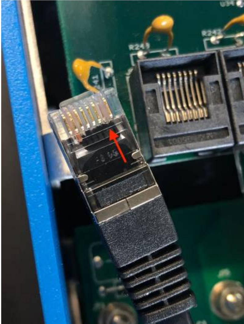
A desvantagem de cortar o pino 7 é a menor eficácia ao desligar o dispositivo VE.Bus. Embora permita o carregamento e a inversão, vai permanecer no modo de espera e assim extrair mais corrente da bateria do que se o pino 7 estivesse na respetiva posição. Normalmente isto só é importante em sistemas marinhos ou automóveis, nos quais é normal desconectar o dispositivo VE.Bus. Para estes sistemas, recomendamos que não corte o pino 7, mas que alimente simplesmente CCGX a partir da bateria.
