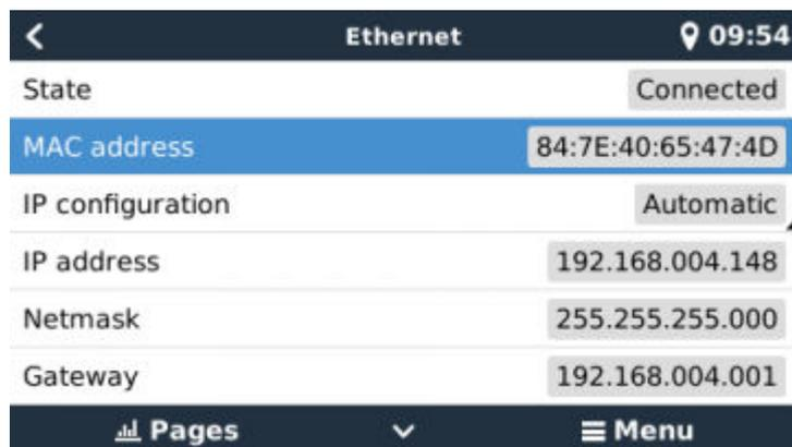
Cuando use Ethernet y el estado muestre “Desenchufado”, compruebe que el cable de red de Ethernet no es defectuoso, para ello pruebe con otro. Las dos luces de la parte posterior del CCGX, donde se enchufa el cable RJ45 de Ethernet, deberían estar encendidas o parpadeando. Si las dos luces están apagadas significa que hay un problema con la conexión.
