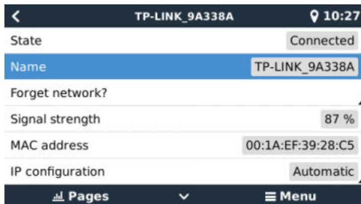
Cuando use Wi-Fi y el menú muestre “Ningún adaptador Wi-Fi conectado” compruebe la conexión USB a la mochila Wi-Fi. Pruebe a retirar la mochila y volver a insertarla.
