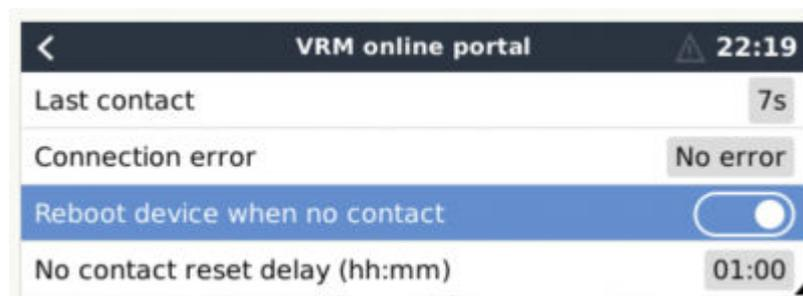
Esta opción, deshabilitada por defecto, hace que el dispositivo GX se reinicie automáticamente en caso de que no se haya podido conectar al portal VRM.
