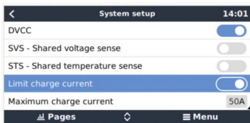
Se puede acceder a este ajuste en el menú "Configuración → "Configuración del sistema" del dispositivo GX.
