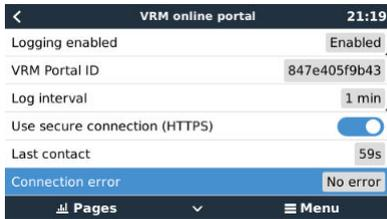
Si aparece un error de conexión, el CCGX no puede entrar en contacto con la base de datos de VRM. El error de conexión mostrará un código de error que indica la naturaleza del problema de conectividad. Además, se mostrarán los detalles del mensaje de error para que los expertos locales de TI puedan diagnosticar el problema.
