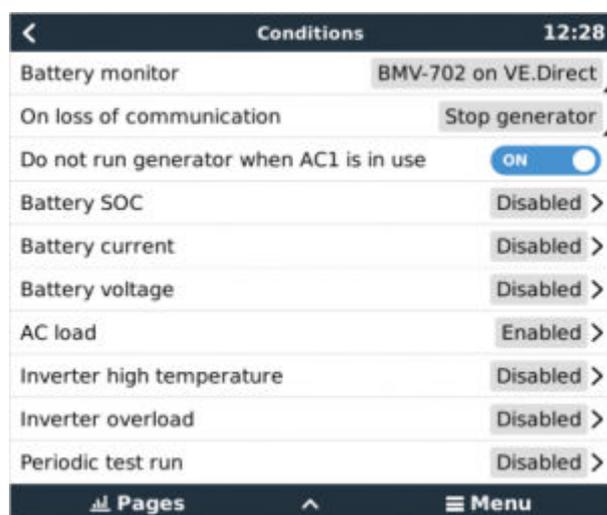
\* **Monitor de batería:** Seleccione cómo se va a hacer el seguimiento de la batería, si procede. Los datos del monitor de la batería se usarán para condiciones relacionadas con CC.
