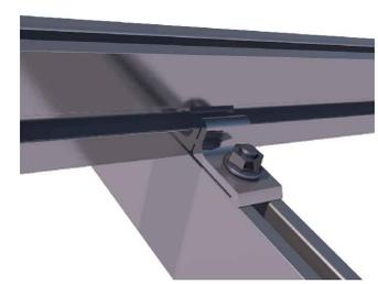
Detalle fijación G1 a triángulo
